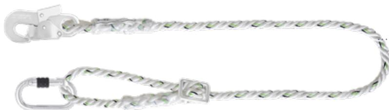
Cordino di posizionamento con fune in trefolo da 14 mm. Pratico sistema di regolazione della lunghezza in alluminio. Comprensivo di un connettore a ghiera in acciaio e un connettore a doppia leva in acciaio con apertura di 18 mm. Lunghezza totale regolabile fino a 2 m.
