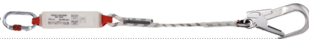
Cordini anticaduta in poliammide da 10,5 mm con assorbitore di energia integrato. Struttura composta con anima interna e calza esterna per la massima resistenza. Certificato per utilizzo orizzontale su spigolo vivo ( $r \geq 0,5$  mm). Estremità rinforzata mediante redancia in polipropilene con clip di bloccaggio in poliammide e guaina di protezione in poliuretano. Comprensivi di un resistente connettore a ghiera in acciaio e un connettore a leva in alluminio con apertura da 60 mm.
