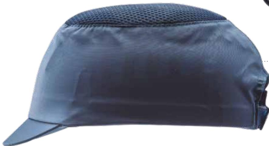
Berretto antiurto in poliestere e cotone altamente traspirante. Fodera a rete interna per maggior comfort. Visiera corta da 3 cm per una massima visibilità. Rigida calotta interna in polietilene con cuscinetto in EVA per ammortizzare gli urti. Taglia regolabile tramite fibbia posteriore, 55-62 cm. Idoneo per lavorazioni a rischio di piccoli impatti o urti accidentali
