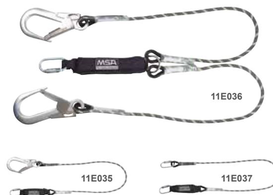
Cordini anticaduta in Nylon da 11 mm, comprensivi di assorbitore di energia. Lunghezza: 1.8 m. Testati ed utilizzabili su spigolo vivo. Idonei per operatori fino a 100 kg. Disponibili in versione singola o doppia.
