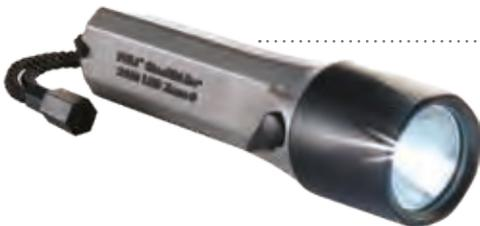
Torcia compatta a LED idonea per aree ATEX Zona 0, intensità luminosa di 153 lumen. Corpo in durevole PC/PBT. Leva laterale per attivazione, pratica anche se montata su un casco. Cordino di sicurezza incluso. Alimentazione tramite 4 batterie AA. Peso: 207 g
