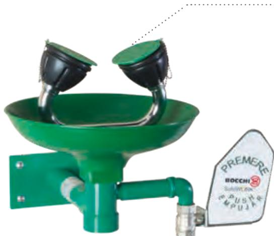
Lavaocchi a parete con vaschetta in resistente polipropilene. Ugelli a flusso aerato per un getto delicato ma corposo fino a 14 l/min. Coppette degli ugelli in morbido EPDM per evitare il rischio di infortuni. Gestione della temperatura dell'acqua tramite valvole apposite. Semplice azionamento con valvola a chiusura manuale per mezzo di una leva a pressione laterale. Speciale verniciatura con trattamento epossidico per una maggiore resistenza agli agenti chimici.
