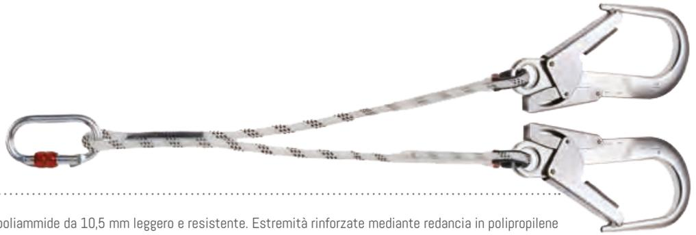
Cordino di trattenuta doppio in poliammide da 10,5 mm leggero e resistente. Estremità rinforzate mediante redancia in polipropilene con clip di bloccaggio in poliammide e guaina di protezione in poliuretano. Comprensivo di un resistente connettore a ghiera in acciaio e due connettori a leva in alluminio con apertura da 60 mm. Lunghezza totale: 1 m
