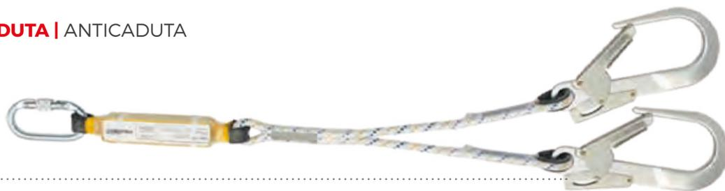
Cordini anticaduta doppio in poliammide da 10,5 mm con assorbitore di energia integrato. Estremità rinforzate mediante redancia e guaina di protezione in poliuretano. Comprensivi di un resistente connettore a ghiera in acciaio e due connettori a leva in alluminio con apertura da 50 mm.
