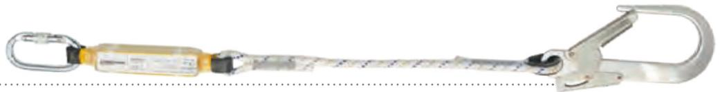
Cordini anticaduta in poliammide da 10,5 mm con assorbitore di energia integrato. Estremità rinforzata mediante redancia e guaina di protezione in poliuretano. Comprensivi di un resistente connettore a ghiera in acciaio e un connettore a leva in alluminio con apertura da 50 mm.
