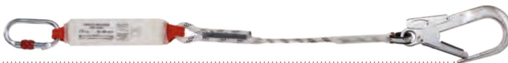
Cordini anticaduta in poliammide da 10,5 mm con assorbitore di energia integrato. Struttura composta con anima interna e calza esterna per la massima resistenza. Certificato per utilizzo orizzontale su spigolo vivo ( $r \geq 0,5$ , mm). Estremità rinforzata mediante redancia in polipropilene con clip di bloccaggio in poliammide e guaina di protezione in poliuretano. Comprensivi di un resistente connettore a ghiera in acciaio e un connettore a leva in alluminio con apertura da 60 mm.
