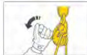
Evacuazione grazie al discensore I'D EVAC, la cui maniglia ergonomica permette di controllare facilmente lo scorrimento della corda durante l'evacuazione.
