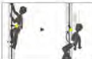
Durante la progressione verticale su guida o cavo, il punto di attacco LADDER CLIMB permette di collegare il carrello in posizione ventrale, ripartendo la tensione sulla cintura e garantendo così un comfort ottimale. In caso di caduta, questo punto di attacco risale automaticamente in posizione sternale per garantire una posizione post-caduta verticale del corpo.
