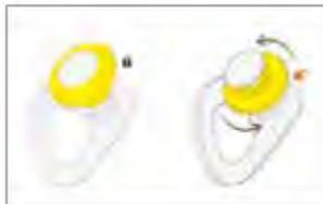
Sistema di bloccaggio manuale a vite per ridurre il rischio di estrazione involontaria.
