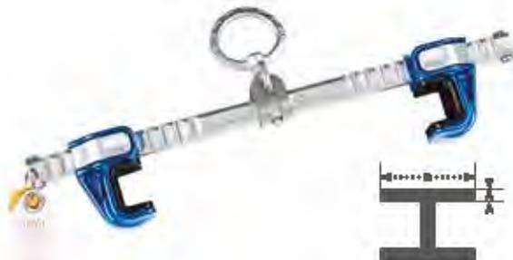
Fissare l'ancoraggio alla trave utilizzando i pulsanti di regolazione, è sufficiente collegare il sistema retrattile (SRL) o il cordino al D-ring orientabile e si è pronti a lavorare. Il punto di ancoraggio scorre senza sforzo dietro l'utilizzatore. Portata di peso dell'utilizzatore: 141 kg.
