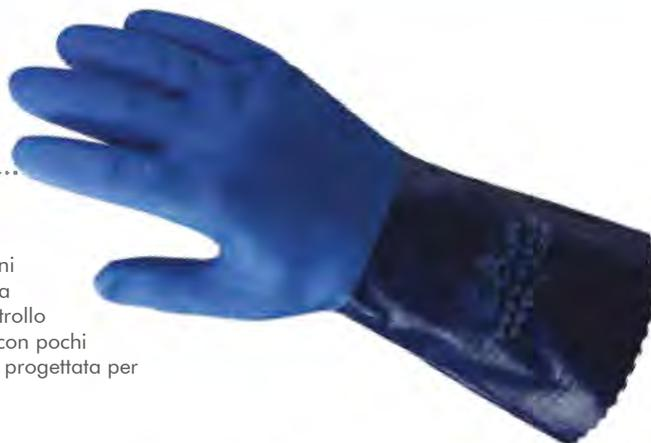
Un guanto morbido e sottile (1,10 mm di spessore). Finitura ruvida con elevata resistenza alle sostanze chimiche ed eccellente resistenza all'abrasione. Il nitrile protegge le mani dalla penetrazione di oli, idrocarburi e grassi. Presa ottimizzata per le attività che richiedono l'uso attento delle mani e un controllo completo degli strumenti di lavoro. Guanto leggero, elastico, con pochi pelucchi e resistente alla deformazione. Maglia senza cuciture progettata per evitare le irritazioni.
